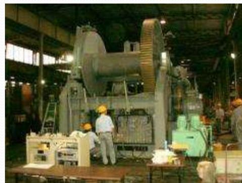
工場内で調整中のアンカーハンドリング／トローイングウインチ
