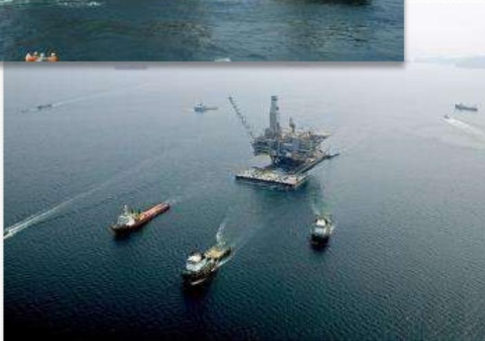
推進力をもたない海洋構造物を当社製のAHTWを搭載したサプライポート3隻で曳航している様子
