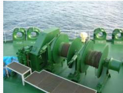
**電動低油圧式ムアリングウインチ**
