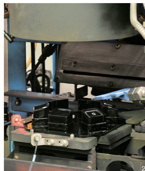
1 エンジンのスイッチの完成品。他にもエアコンやオーディオ操作パネルなど、快適なカーライフには欠かせないものばかり 2 製品にレーザー光を照射し、文字や絵柄を彫る 3 自動化されたスピンドル塗装
