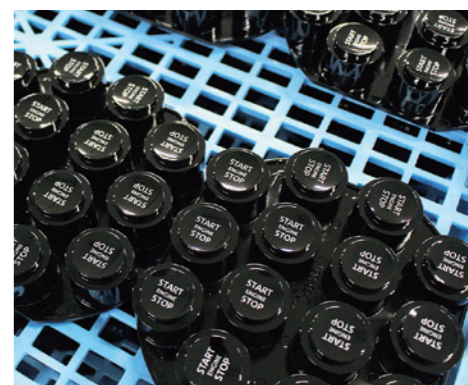
1 エンジンのスイッチの完成品。他にもエアコンやオーディオ操作パネルなど、快適なカーライフには欠かせないものばかり 2 製品にレーザー光を照射し、文字や絵柄を彫る 3 自動化されたスピンドル塗装
