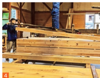
4 仕上工程（選別）が行われている様子 5 最終工程は乾燥。コンテナのような大きな乾燥機に1週間ほど入れ、高温で水分を抜く。自然乾燥だと約2年掛かるが、乾燥機の場合は約1カ月まで工期を短縮
