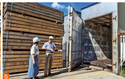
4 仕上工程（選別）が行われている様子 5 最終工程は乾燥。コンテナのような大きな乾燥機に1週間ほど入れ、高温で水分を抜く。自然乾燥だと約2年掛かるが、乾燥機の場合は約1カ月まで工期を短縮
